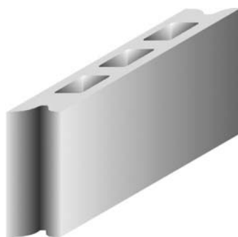
BETONSKI BLOK 40 X 20 X 9 MASA 10Kg UTROŠAK 12,5 kom/m 2
